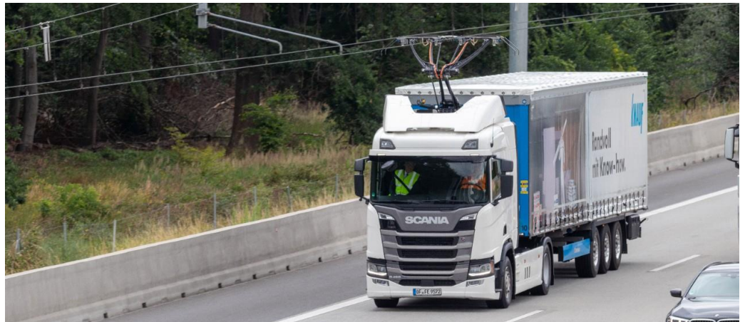
Figuur 4-6 Stroomafnemer op voertuig (www.scania.com)
